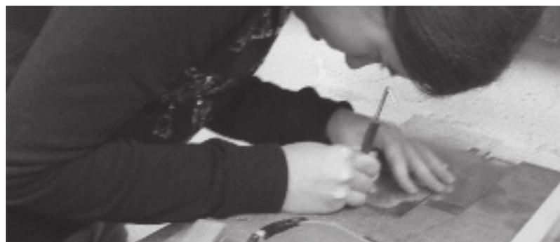
Beim Biegen mussten wir sehr genau arbeiten, das war nicht immer einfach. Zur Hilfe nahmen wir Biegeholz und Schraubstock.
