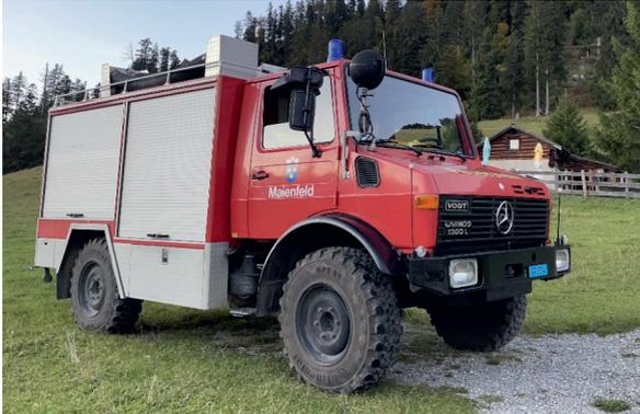
Das zurzeit im Dienst stehende Tanklöschfahrzeug Unimog U-1300 (Jahrgang 1987) erfüllt die Anforderungen an ein Einsatzfahrzeug aus technischen Gründen (Reparaturanfälligkeit, Ausfallrisiko) nicht mehr. Zudem entspricht das Fahrzeug nicht mehr den heutigen Sicherheitsanforderungen. So ist das Tanklöschfahrzeug beispielsweise nicht mit Sicherheitsgurten für den Fahrer sowie die Mitfahrer ausgerüstet.
