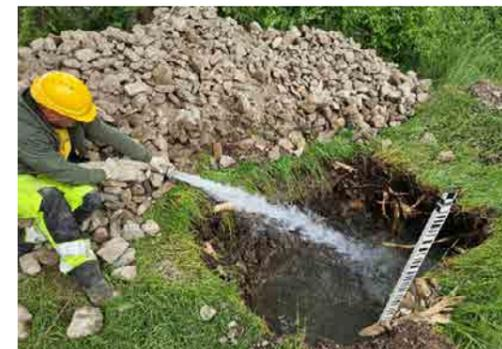
In Situ Sickerversuch (Bild zvg DP MM)
