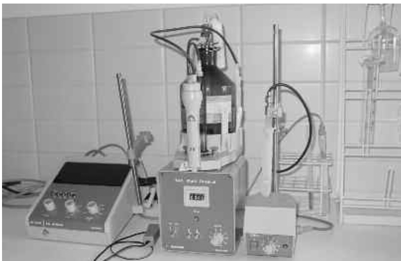
Dieses Titrations-Gerät steht den Winzern täglich im Plantahof kostenlos zur Verfügung zur qualitativen Bestimmung der Säuren im Wein.
